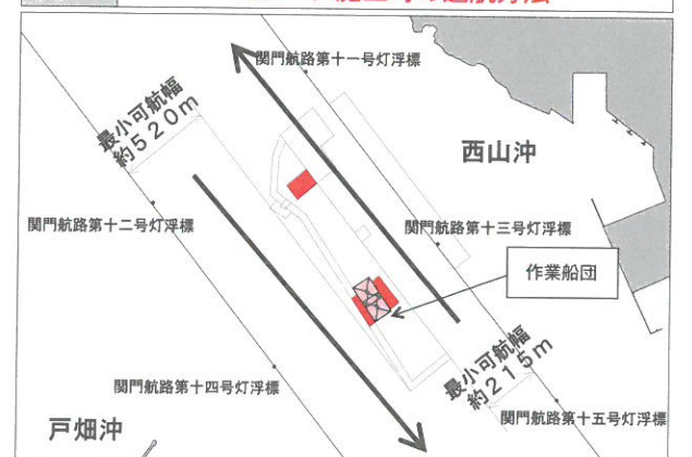
図-5 2レーン施工時の通航方法
