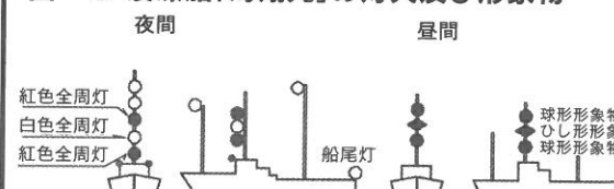
図-8 浚渫船「海翔丸」の灯火及び形象物
