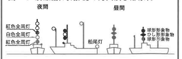
図-8 浅瀬船「海翔丸」の灯火及び形象物
