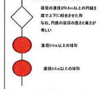
作業船に掲げる形象物
